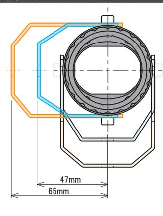
クーリングデフューザー装着時の汎用ステー取り付けイメージ
