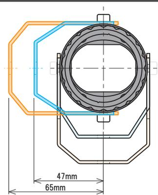
クーリングデフューザー装着時の汎用ステー取り付けイメージ
