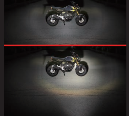
ノーマルヘッドライトにフォグランプ1灯有無の比較 上:無し/下:有り(1灯乗車時右装着)
