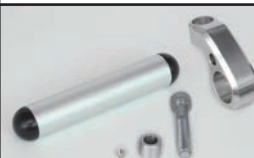
対象車両:CT125・ハンターカブ (JA55) ブラケットはアルミ材を精巧に削り出し、表面にアルマイトを施しています。Φ22.2アルミ製パイプのハンドルガードはショットプラスト後、アルマイトを施しています。
