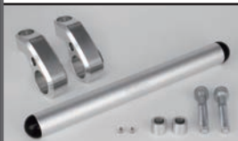
対象車両:CT125・ハンターカブ (JA55) ブラケットはアルミ材を精巧に削り出し、表面にアルマイトを施しています。Φ22.2アルミ製パイプのハンドルガードはショットプラスト後、アルマイトを施しています。
