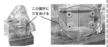
・取り外したエンジン固定台に発送するエンジンを付属のフラットヘッド スクリュー8×45を2本使用し、エンジンのステップ取り付けボルト 穴へ固定します。
