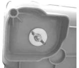
入れ込みが完了すれば以前の作業で取り外した蝶ネジ(エンジン固定台側、蝶ナット(エンジン梱包箱側) ワッシャ(エンジン梱包箱側)を使用し締め付け、梱包箱に取り付けます。
