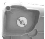
・エンジンに付属の袋に入れ、エンジン下ステップ取り付け部分に穴を あけます。
