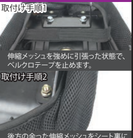
後方の余った伸縮メッシュをシート裏にあるシートステーの間に挟み込みます。
