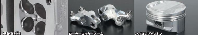
■スーパーヘッド4V+R シリンダーヘッド詳細 ヘッドの表面は、無塗装の「シルバー」を採用。インテーク/エキゾーストバルブを各2本ずつにする事でVバルブ、アン面積を拡大し、高い吸排気効率を実現しました。4バルブ化に伴う、センタープラグ化、バルブ狭み角、燃焼室形状、ボルト形状をオリジナルヘッド形状の為、ノーマルヘッドでは得る事が出来ない高出力を実現しました。燃焼室はNC加工により、高精度に仕上げられています。インスパベクションリザーカカバー、インスパベクションカバー、シリンダーヘッドサイドカバーはアルミダイカスト製バルブ研磨仕上げ
