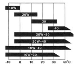
注) エンジンオイルは、推奨エンジンオイルをご使用下さい。エンジンオイルの種類によっては、添加剤等が含まれている物が存在し、その様なエンジンオイルを使用した場合、エンジンに悪影響を与えるだけではなく最悪の場合、部品破損によりエンジンを破損させる可能性があります。
