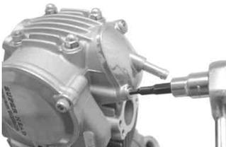
カムチェーンテンショナー部のサイドボルトを締め付けます。
