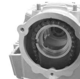
シリンダーヘッドスタットネジ部にアルミスペシャルを少量塗布し、左下部（オイルライン）にキット内の銅ワッシャ、他の部分にキット内のワッシャを取り付け、キット内のフクロナット4個、キット内のキャップスクリュー6×18を図の様に取り付け、仮締めをします。
