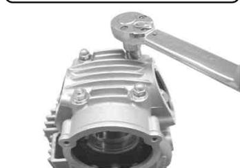
シリンダーサイド部のサイドボルト及びシリンダーヘッドサイド部のキャップスクリューを規定トルクまで締め付けます。
