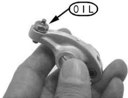
スーパーヘッドにロッカーアームを取り付けます。オリジナルのロッカーアームシャフトに、モリブデン溶液を塗布し、エキゾースト側に取り付け、キット内のロッカーアームシャフトにもモリブデン溶液を塗布し、切り裂き部分が有る方をカムチェーン側方向に取り付けます。
