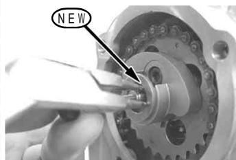
右サイドカバーのOリング2種類に少量のエンジンオイルを塗布し、右サイドカバーに取り付け、キット内のキャップスクリュー5×12を用いて取り付け規定トルクまで締め付けます。
