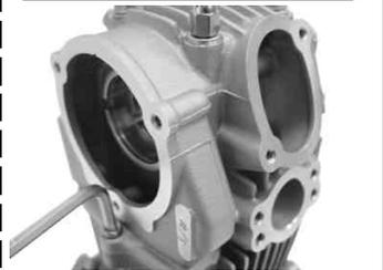
シリンダーのカムチェーンガイドローラーを規定トルクまで締め付けます。
