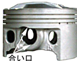
ピストンリング部及び、ピストンピン部をエアブローし、異物の噛み込みが無い事を確認します。
