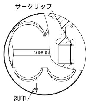
**サークリップは必ず上記図の方向に取り付けて下さい。**
