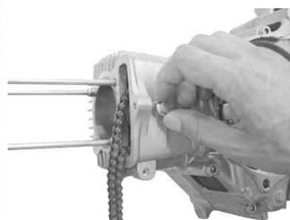
シリンダーサイド部のクランクケースと結合するオリジナルの六角ボルトを仮締めします。シリンダーヘッドを取扱説明書に従い取り付けます。
