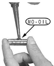
ピストンの矢印がある方をエキゾーストに向け、コネクティングロッドにピストンを取り付けます。ピンが入りにくい場合は、たたき込んだりせず、サインペン等を使用し、ゆっくり差し込んで下さい。
