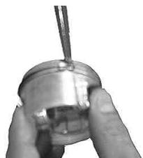
リング側面にシルバー色コーティングがある方がトップリングです。間違わない様に取り付けて下さい。
