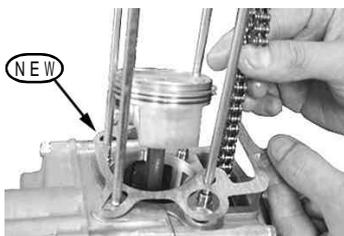
クランクケースのシリンダーベース面のオイルリターン穴部にキット内の新品のラバーパッキン16mmを取り付けます。
