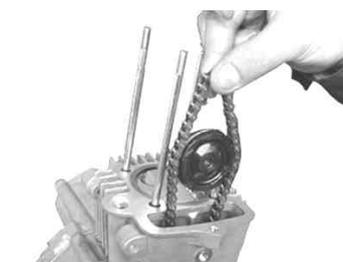
カムチェーンガイドローラーと、シリンダーサイドボルトを仮締めします。
