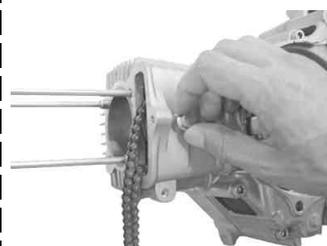
シリンダーサイド部のクランクケースと結合するオリジナルの六角ボルトを仮締めします。シリンダーヘッドを取扱説明書従い取り付けます。
