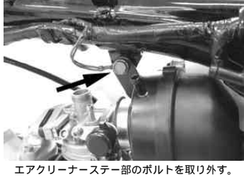
エアクリーナーステー部のボルトを取り外す。 使用工具 ボックスレンチ 10mm エクステンションバー 小
