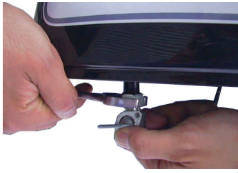
フューエルコックをフューエルタンクから取り外し、キットの物を取り付ける。 使用工具 スパナレンチ 19mm
