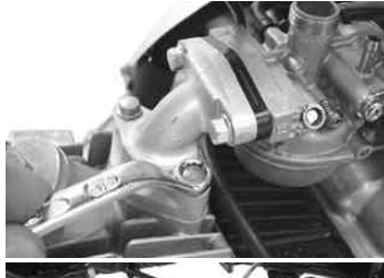
エアクリーナーステー部のボルトを取り外す。 使用工具 ボックスレンチ 10mm エクステンションバー 小
