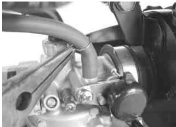
フューエルコックをフューエルタンクから取り外し、キットの物を取り付ける。 使用工具 スパナレンチ 19mm
