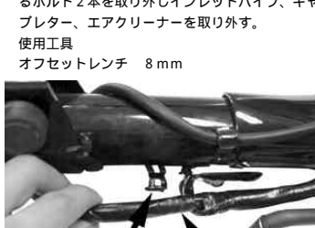
クランプ ワイヤーハーネス ワイヤーハーネスをフレームの下側になるように移動させる。
