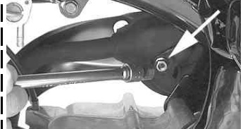
マフラー本体裏側に止まっているナットを反時計方向に回し取り外す。 使用工具 ボックスレンチ 10mm エクステンションバー 中
