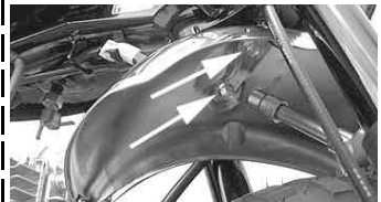
フロントフェンダー裏側の6角ボルト2本を反時計方向に回し取り外す。 使用工具 ボックスレンチ 10mm エクステンションバー 小
