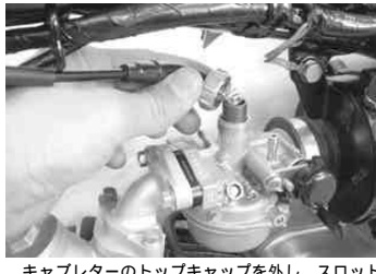
キャブレターのトップキャップを外し、スロットルバルブをキャブレターから抜き取る。
