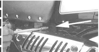
マフラー本体を止めている6角ボルトを反時計方向に回し取り外す。 使用工具 ボックスレンチ 12mm エクステンションバー 中
