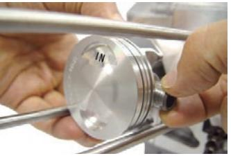
◇ピストンpinサークリップ溝にピストンpinサークリップを取り付ける。
