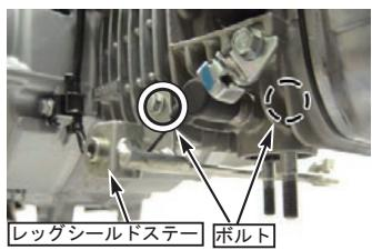
◇ボルトを取り外し、シリンダーヘッドのO<sub>2</sub>センサーガードを取り外す。O<sub>2</sub>センサーのキャップを取り外す。スパークプラグキャップを取り外す。
