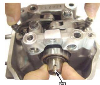
◇シリンダーへッドにボルトワッシャを仮止めする。
