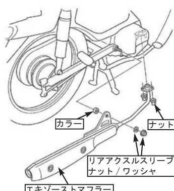
◇各部を規定トルクにて締め付ける。
