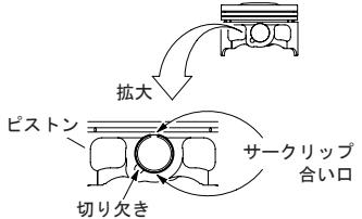
◇コンロッド小端部、ピストンピン穴にエンジンオイルを塗布しピストンpinにモリブデングリスを塗布しピストン頭部にある“IN”マークをインテーク側に向かってピストンpinを取り付ける。
