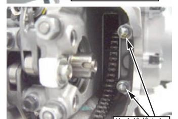
◇シリンダーヘッドナット4個を対角に数回に分けて緩め、シリンダーヘッドナットと共にワッシャ4個を取り外す。
