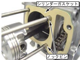
◇ピストンリング部にエンジンオイルを塗布し、なじませる。シリンダー内周部を清掃した後にエンジンオイルを塗布する。カムチェーンをシリンダーに通し、ピストンリングを指で圧縮しながらシリンダーを取り付ける。
