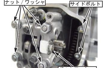
◇シリンダーへッドナット4個を対角に数回に分けて締め付け、規定トルクにて締め付ける。
