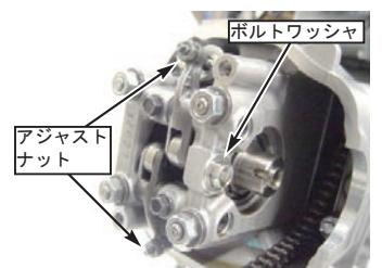
◇シリンダーのガイドローラーボルトを緩めておく。シリンダーヘッドのサイドボルト2本を取り外す。
