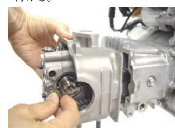
◇ワッシャ4個、シリンダーへッドナット4個、シリンダーへッドのサイドボルト2本を取り付ける。
