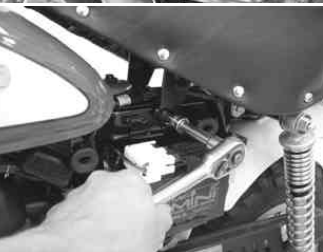
シート下のナットを緩め、ボルトを取り外す。 使用工具 ボックスレンチ 12mm エクステンションバー 小 オフセットレンチ 10mm
