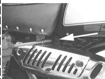
マフラー本体を止めている六角ボルトを反時計方向に回し取り外す。
