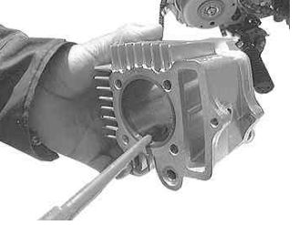
ノックピン2個が取り付けられているか検核。
