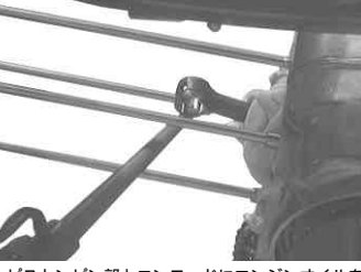
ピストンピン部とコンロッドにエンジンオイルを塗りピストンピンを取り付ける。
