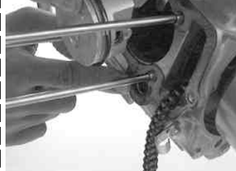
シリンダーベースガスケットとブラックのラバーパッキンを取り付ける。
