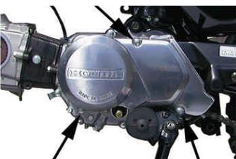
クランクケース左カバーを止めているスクリー3本を取り付ける。
