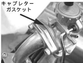
PC18キャブレターとインテイクマニホールドにキャブレターガスケットをはさみ、ソケットキャップスクリー6×20 2本で取り付ける。
