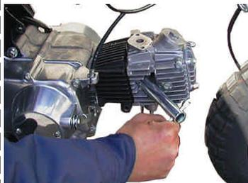
車載工具かスパークプラグレンチを使いプラグを取り付ける。
