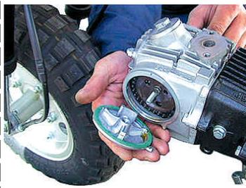
シリンダーヘッド左カバーガスケットと左カバーを取り付ける。
