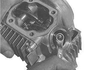
シリンダーヘッドに組まれているロッカーアームのタベットナットとボルトを取り外す。タベットナットを緩めた時点でタベットボルトをナットと一緒に取り外す。
