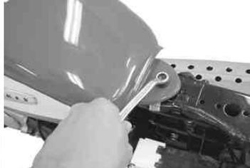
フューエルタンクをフレームにボルトで取り付ける。
