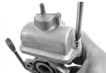
フロートチャンパーを取り付け、2本のスクリーでキャブレターに取り付けます。
