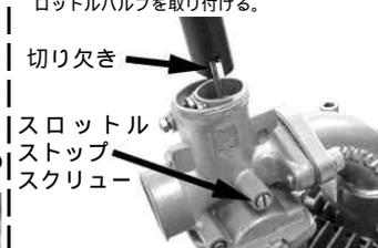
スロットルバルブの切り欠き部をスロットルストップスクリーに合わせてキャブレターに差し込み、取り付ける。
