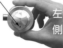
ドライバーでピストンにキズを付けないように押し込むと比較的簡単に取り付けられます。ピストンサークリップは左側を先にはめ込みます。
