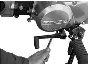
シフトペダルの六角ボルトを外しシフトペダルを反時計方向に回し取り外す。
