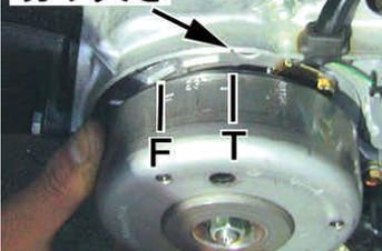
フライホイールのTマークをクランクケースの切り欠き部に合わせる。
