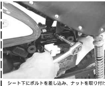
シート下にボルトを差し込み、ナットを取り付ける。
