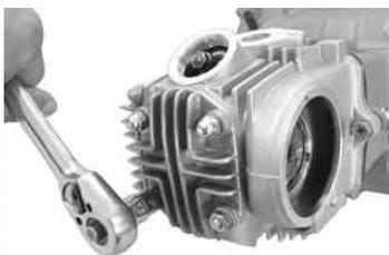
シリンダーヘッドカバーを止めているナット4個を対角の順番に反時計方向へ回し取り外す。ナット下にあるワッシャ4枚を取り外す。
