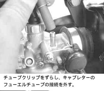
チューブクリップをずらし、キャブレターのフューエルチューブの接続を外す。
