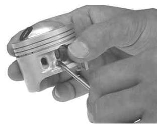
ピストンの片側に付属のピストンピンサークリップをサークリップ溝にきっちりめ込む。この時、サークリップの合い口は切り欠き部を避けて取り付けして下さい。
