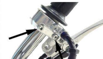
アッパースロットルハウジングを2本のスクリーで取り付ける。
