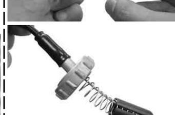
スロットルケーブルにトップキャップを取り付け、スプリングを入れてインナーケーブルにスロットルバルブを取り付ける。
