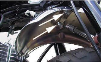
フロントフェンダー裏側の六角ボルト2本を締めて取り付ける。
