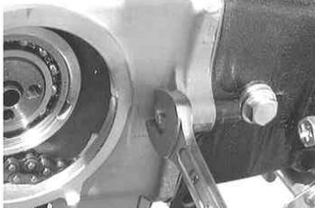
シリンダーヘッドとシリンダーを止めているシリンダーヘッドサイドボルトを反時計方向に回し取り外す。
