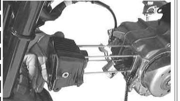
ピストンが抜けたらタイヤを手で押さえながらシリンダーを前方へ取り外す。
