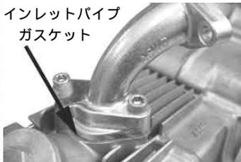
インテイクマニホールドとシリンダーヘッドにインレットパイプガスケットをはさみ、ソケットキャップスクリー6×25 2本で取り付ける。
