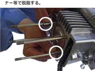
シリンダーにロックピン2個を取り付ける。
