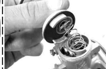
キャブレターのくぼみにトップキャップの凸を合わせて取り付けます。
