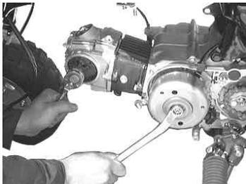
フライホイールを固定しカムスプロケット六角ボルト2個を反時計方向に回し取り外す。
