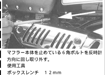
マフラー本体を止めている六角ボルトを反時計方向に回し取り外す。 使用工具 ボックスレンチ 12mm エクステンションバー 中
