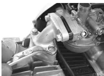
インレットパイプをシリンダーヘッドにとめているボルト2本を取り外しインレットパイプ、キャブレター、エアクリーナーを取り外す。 使用工具 オフセットレンチ 8mm
