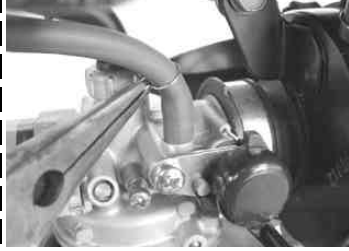
チューブクリップをずらし、キャブレターのフューエルチューブの接続を外す。
