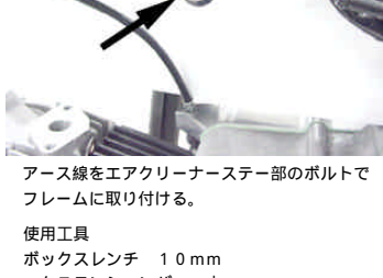
使用工具 ボックスレンチ 10mm エクステンションバー 小 規定トルク 1.2N・m(1.2kgf・m)
