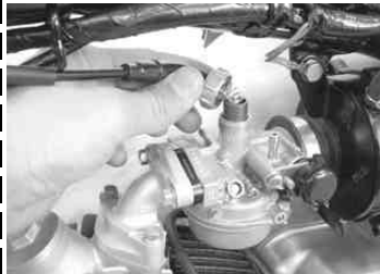
キャブレターのトップキャップを外し、スロットルバルブをキャブレターから抜き取る。
