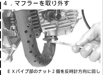
EXパイプ部のナット2個を反時計方向に回し取り外す。 使用工具 スパナレンチ 10mm
