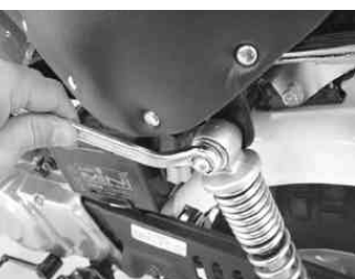
リアショックのナット2個をゆるめる。 使用工具 オフセットレンチ 14mm
