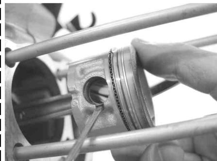
ピストンピン穴の切り欠き部を利用してこじると外れやすい。クランクケース内に入らないように注意。
