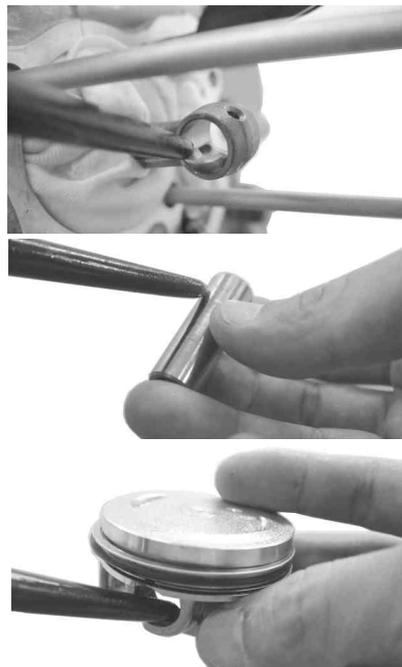
ピストン頂面の“ ”マークを下側(排気側)に向けてコンロッドに取り付ける。付属のピストンピンサークリップをもう片方のピン穴に取り付ける。ピストンの全周面とピストンリングにエンジンオイルを塗布し、各リングが滑らかに回転することを確認する。ピストンリングの合い口はピストンピン方向とその直角方向を避け、120度間隔にする(左下図参照)。
