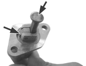
付属のガスケットとカムチェーンテンショナーをシリンダーにボルト/ワッシャで取り付ける。Oリングがついていることを確認し、スプリングとキャップボルトを取り付ける。
