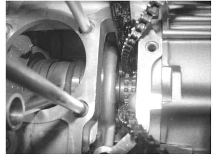
クランクケースと付属のシリンダーの合せ面をシンナー等で脱脂し、きれいにする。ノックピン2個と付属のシリンダーガスケットをクランクケースに取り付ける。
