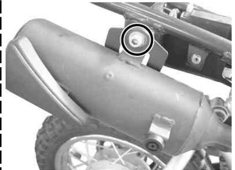
仮止め部を規定トルクで締め付ける。
