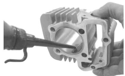
シリンダーをピストンリングの合い口の位置がずれないように指で少しずつピストンにはめていき、シリンダーをクランクケースにはめ込む。
