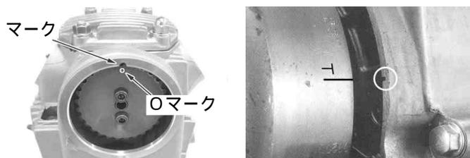
クランクを固定し、カムスプロケットを固定しているキャップスクリューを規定トルクまで締め付けます。
