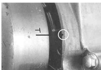
カムシャフトに8×12ノックピンを差し込み、カムチェーンをカムスプロケットに取り付け、キャップスクリューM5×12(黒色)2本を用いて取り付けます。
