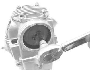
クランクシャフトを反時計方向に2回転以上回し、フライホイールの“T”マークと、カムスプロケットの“O”マークが合っているか確認します。
