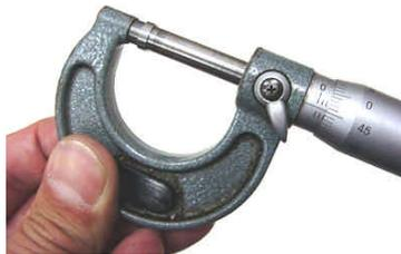
$$\begin{aligned} \text{新しいシムの厚さ} &= \text{取り外したシムの厚さ} \\ &+ (\text{測定したバルブクリアランス} \\ &- \text{規定のバルブクリアランス}) \end{aligned}$$
