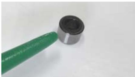
○②カムチェーンテンショナーローラーにエンジンオイルを塗布して①アーム COMP. に取り付け、ノーマルのカラーと③ワッシャ 8.5x22x3.2 とノーマルのフランジボルトにて取り付け、規定トルクで締め付ける。
