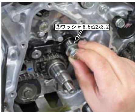
○プッシュロッド、テンショナー springs を取り付け、新品のシーリングワッシャと共にカムチェーンテンショナーシーリングボルトを規定トルクで締め付ける。
