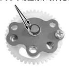
゙∆ 注意:オイルポンプを分解し、裏面のプレート固定スクリューを締 め付ける際、必ずシャフトを回転させてプレートとシャフト に干渉が無く引っ掛かりや抵抗が無い位置にプレートを調整 して組付けて下さい。
