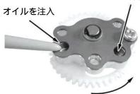
ギアを回転させて反対側にオイルを循環させる
