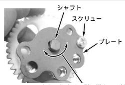
シャフトを回転させて引っ掛かりや抵抗が無い 位置にプレートを調整して組み付けて下さい
