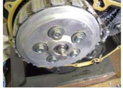
○クラッチプレッシャープレートボルトを対角に2~3回に分けて規定トルクで締め付ける。
