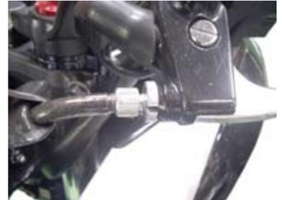
○調整後、アジャストナットを固定し、ロックナットを締め付ける。
