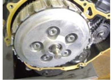
○クラッチスプリングを取り付けクラッチプレッシャープレートボルトを取り付ける。
