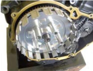
○キット付属のクラッチセンターロックナットの座面にエンジンオイルを塗布する。
