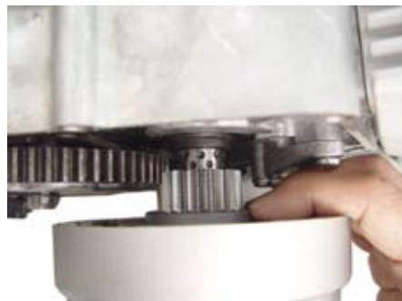
○キットの 14mm ロックワッシャの爪をドライブプレートの溝に合わせて取り付けます。
