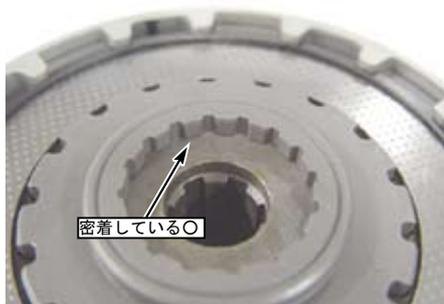
☆隙間があると、中のフリクションディスクとクラッチセンタが噛み合っていない可能性があり、クラッチが切れないという事態になる場合もありますので、必ず確認して下さい。又、隙間がある場合は必ず密着させて下さい。
