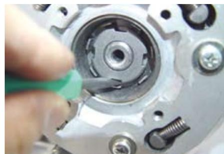
○クラッチアウトを保持し、ロックナットレンチを用いてロックナットを取り外します。
