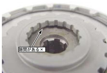
○キットのクラッチ ASSY. のクラッチセンタの溝にプライマリドライブギアの歯を合わせて取り付けます。
