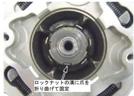
○キットのガスケットをクラッチアウトカバーに取り付け、クラッチアウトにスクリュー4本で取り付けます。クラッチアウトカバーに、リフトベアリング（再使用）、オイルスルーガイド、オイルスルースプリング、オイルスルーを取り付けます。
