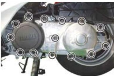
○ユニバーサルホルダにてドライブフェイスを固定し、ドライブフェイスナットとワッシャを取り外し、ドライブフェイス、ランププレート / ドライブフェイスボス / プーリーを取り外す。
