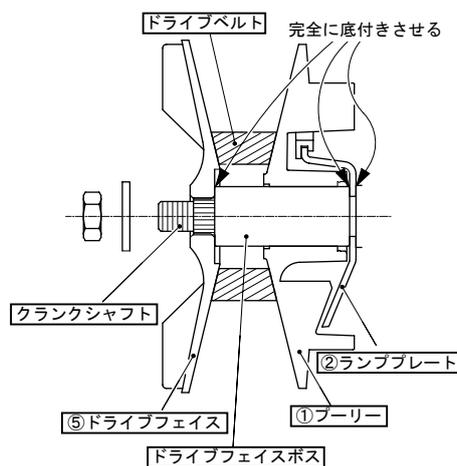
○ドライブフェイスナットとワッシャの座面に推奨グリスをごく少量塗布してから取り付け、ユニバーサルホルダにて⑤ドライブフェイスを固定しながら規定トルクにて締め付ける。
