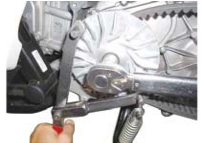
○⑤ドライブフェイスを数回転手で回し、ドライブベルトをなじませる。
