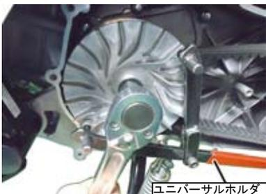
○付属の①プーリーに付属の④ウエイトローラー(10g)をセットし、ノーマルのドライブフェイスボスと付属の②ランププレート / ③スライドピースを取り付ける。
