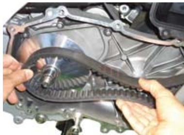
○付属の⑤ドライブフェイスをクランクシャフトのスプライン形状に合わせて取り付ける。
