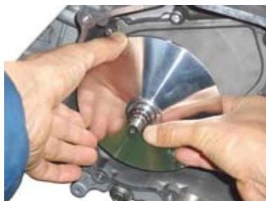
○ドライブベルトをドライブフェイスボスに通す。
