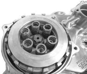
クラッチスプリングを硬くしたい場合、クラッチセンターのspring座面部に写真の様にキット付属のシムを取り付けてからスプリングを取り付けて下さい。
