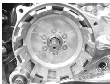
クラッチアウターを取り外す時、抜けにくい場合は2つのM5タップ部にフラットヘッドスクリューを均一に締め込むとプライマードライブギアASSYから分離します。
