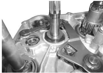
3. プライマードライブギアASSYのボールベアリング部にエンジンオイルをオイルシール部にグリスを塗布し、メインシャフトに差し込みます。
