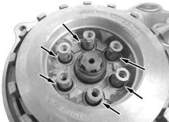
7. クラッチリフタープレートのベアリング面を外側にして6角ボルト5×20にワッシャを組み付け手でいっぱい締め付けます。クラッチリフタープレートを手で引っ張りフリクションディスクに隙間が出来るときはクラッチセンターとクラッチプレッシャープレートの噛合わせがずれています。その際は、クラッチリフタープレートを左右に回転させ、クラッチセンターとクラッチプレッシャープレートを噛合わせます。噛合った状態でクラッチリフタープレートを手前に引っ張りながら6角ボルト5×20を対角に徐々に締め付け、最後に規定トルクで締め付けます。
