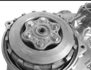
8. 油圧式のクラッチカバーキット装着車両は、クラッチリフタープレートCOMPのベアリングにクラッチリフターロッドを組み付けます。
