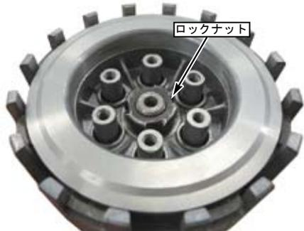
・クラッチプレッシャープレートのボス部にクラッチスプリングを取り付けます。
