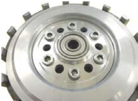
・クラッチリフタープレートCOMP. のベアリング面にクラッチリフターロッドを組み付けます。
