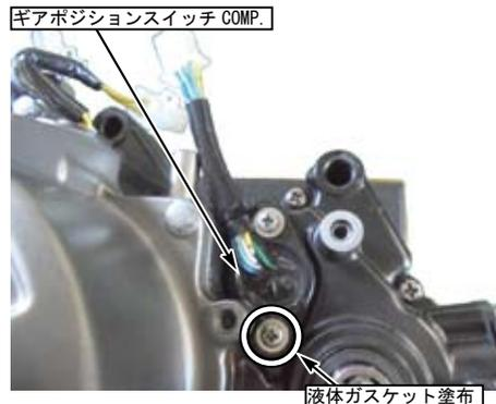
5. 先端のカプラーを純正品ニュートラルスイッチが着いていた車両側カプラーへ接続します。
