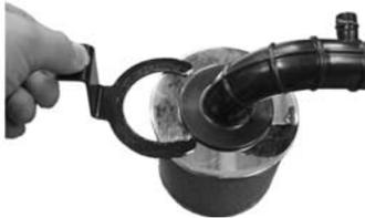
※接着面は汚れ、油脂分を取り除き、十分乾燥させた後、08CRD-B010S0又は相当品を薄く塗布し、接着面が乾かないうちに取り付けます。
