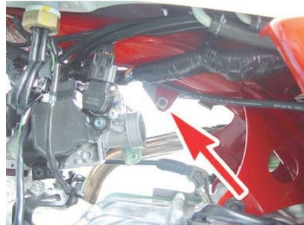
2. エアフィルター COMP. のラバーにクランプバンドを通してから、純正スロットルボディに取り付けます。
