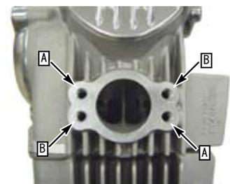
○シリンダーヘッドとインレットパイプの間にインレットパイプガスケットを挟み、6x25のソケットキャップスクリューを用いて取り付け締め付けます。
