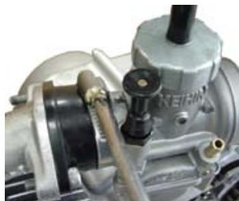
○エアフィルターを取り付け、バンドを締め付けて固定します。
