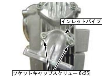
○インレットパイプにインシュレーターをソケットキャップスクリュー 2本を用いて締め付けます。
