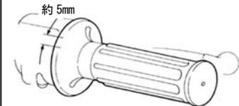
○スロットルを数回スナップさせ引っかけりやスロットルバルブの全開状態を確認します。
