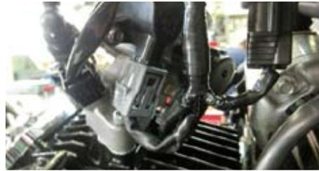
MSX125 に使用する場合は、ファストアイドルソレノイドバルブの代わりにブラインドプラグの取り付けが必要になります。キット付属のブラインドプラグにOリング6mmを取り付けます。
