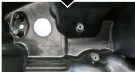
コネクティングチューブ取り付け穴に付属の型紙を宛がい拡大加工します。
