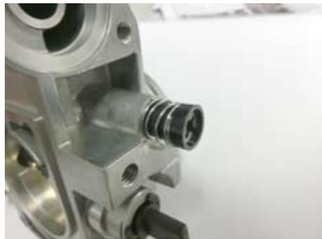
ラバーパッキンと取り外したパーツをビッグスロットルボディに取り付け、規定トルクで締め付けます。
