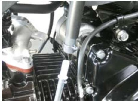
フランジボルトを外し、ノーマルスロットルボディを取り外します。ノーマルスロットルボディより、アイドルエアスクリュー (L)、スプリング、スロットルケーブルブラケット (M)、トルクススクリュー (N)、ファストアイドルソレノイドバルブ (O) ※MSx125にはありません、スプリング、バルブシート (P)、Oリング、スロットル開度センサー (Q) を外します。
