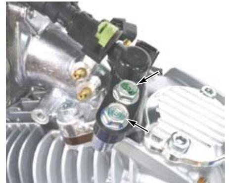
○インナーケーブル 2本をスロットルドラムに接続し、スロットルケーブルをケーブルホルダーに取り付け、スロットルグリップの遊びが適正な範囲になる様にアジャスタを回して遊びの調整を行う。
