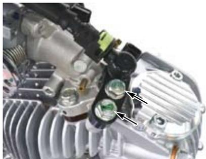
○インレットパイプのボルト2本を取り外し、マニホールド/スロットルボディとインシュレーターをシリンダーヘッドから取り出す。
