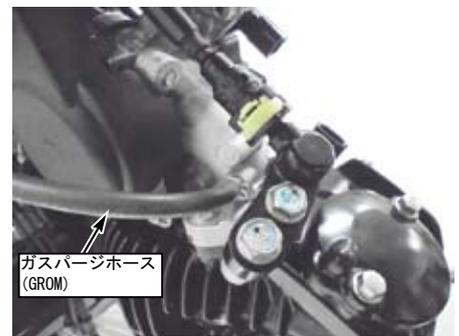
○ボルトワッシャを取り外し、スロットルドラムカバーを取り外す。
