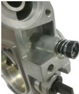
○②ラバーパッキンを取り付けた①ビッグスロットルボディを⑥ソケットキャップスクリュー6x20 2本を使用して③インテークマニホールドCOMP.に取り付ける。
