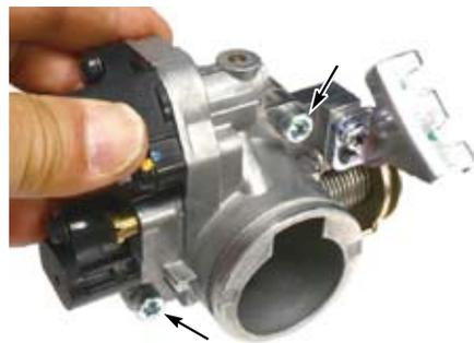
※ビッグスロットルボディ→エアフィルターCOMP.→ブリーザーホースの順の取り付けは困難な為、以下手順にて組み付ける。
