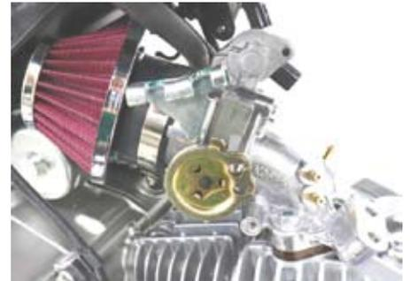
○別売りの弊社製インジェクタ ASSY. とノーマルのシールリングを③インテークマニホールド COMP. に差し込み、インジェクタジョイントをボルト 2本にて取り付けする。
