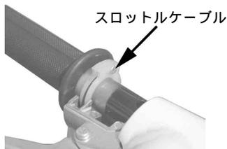
2. スロットル摺動面にグリースを塗布し、スロットルハウジングを取り付けます。パンスクリューを締め付けます。
