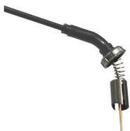
7. スロットルバルブの切り欠き部をスロットルストップスクリューに合わせてキャブレターに取り付けます。
