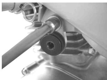
シリンダーヘッドに取り付けた、エキゾーストパイプフランジにキット内のエキゾーストパイプのカラー部に取り付けた、エキゾーストパイプシールを圧縮しながら、エキゾーストパイプフランジに差し込み、一旦、緩めたステーとエキゾーストパイプをノーマルのフランジボルトと、キット内のフランジナットを用いて仮付けします。
