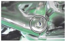
○①マフラー COMP. ジョイント部の④バンド (32-35mm) を規定トルクまで締め付けます。
