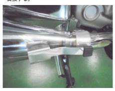
○ノーマルマフラーにプロテクターが取り付けられていた状態と同様に、①マフラー COMP. に ノーマルのソケットボルトでプロテクターを 取り付けます。
