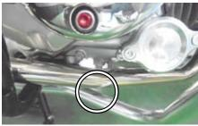
○③エキゾーストパイプフランジ部のジョイント ナットを均等に規定トルクまで締め付けます。
