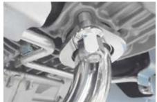
○ステー部のマフラーマウントナットを規定 トルクまで締め付け、マウントボルトを規定 トルクまで締め付けます。
