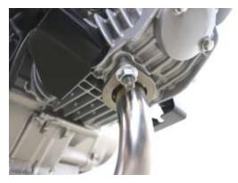
○①パイプ COMP. に②サイレンサー ASSY. を差し込み、純正エキゾーストマフラー COMP. を車両に固定していたプレーンワッシャとフランジボルト8x40で④ステー COMP. を使用し仮締めします。
