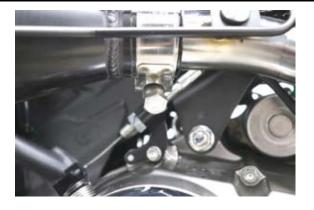
○①パイプ COMP. ボス部に純正エキゾーストパイププロテクターを純正 パンスクリュー 6x12 で取り付け締め付けます。
