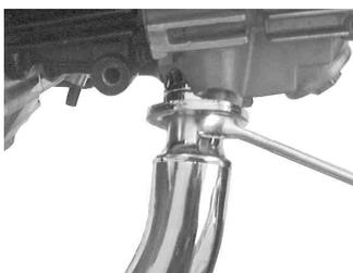
シリンダーヘッドEXポート部のSTDナットを均等に規定トルクまで締め付けます。
