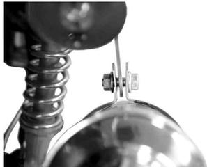
マフラーボディCOMP をエキゾーストパイプCOMP .に差し込み、サイレンサー部をクランプバンドで、マフラーステ - を挟み込む様、フランジソケットキャップスクリューM8×20、フランジナットを用いて仮締めします。
