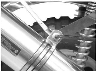
クランプバンド部のフランジソケットキャップスクリューを規定トルクまで締め付けます。
