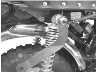
マフラステーをピボットナットに、フランジソケットキャップスクリューM8×16、を用いて仮締めします。
