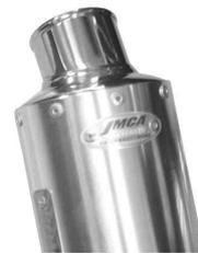
マフラーCOMPのサイレンサー部のネームプレート及びJMC Aプレートの保護フィルムをはがします。
