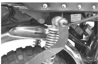
ピボットナット部のフランジソケットキャップスクリューを規定トルクまで締め付けます。
