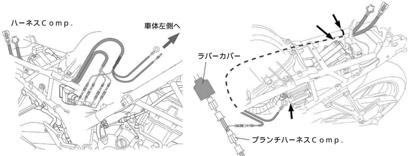
純正ECUに接続されているメインハーネスのカバーを開き、キット付属のサブコード - 1 (黒/青コード)とサブコード - 2 (黄コード)を、メインハーネスの同色コードにそれぞれエレクトロタップで接続します。桃/白コードのECU側にギボシオス端子を、メインハーネス側にギボシメス端子を取り付けます。
