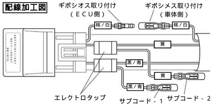
キット付属のハーネス - 1 Comp. とハーネス - 2 Comp. を、車両のECUあたりからタンデムシート下の工具収納スペースまで、フレームの内側を通します。
