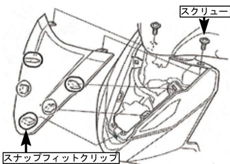
2. バックミラーを取り外し、ハンドルバーフロントカバーを取り外します。
