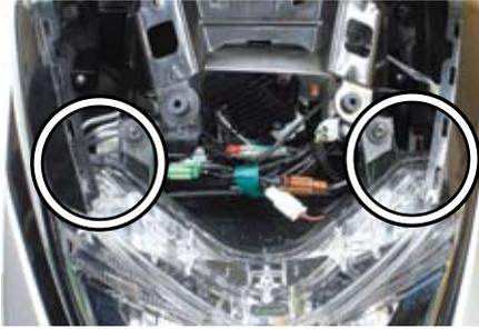
4. 左側（乗車時）にあるウインカーリレーを付属のワイドレンジフラッシャーリレーに交換します。
