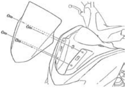
2. スクリューを外し、フロントアッパーパネルを取り外します。
