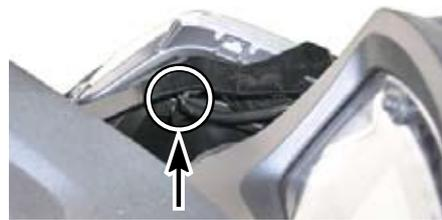
5. リアカバーとグラブバーを取り外し、リアウィンカーライトバルブを交換します。
