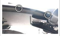
○マッドガード ASSY. を取り外す為に、 ウインカーのギボシとナンバー灯のカプラーを 抜き、ナット 4 個を外して、マッドガード ASSY. を取り外します。
