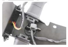
〇リアフェンダーカバーからナットを2つ取り 外し、純正テールランプとテールランプの 土台のラバーを取り外します。
