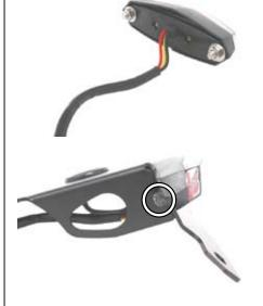
○マッドガードから純正ウインカーを①ステーに 移設します。
