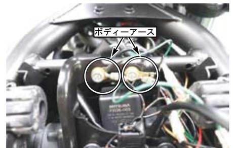
○配線接続が完了しましたら、バッテリーのマイナス端子を取り付け、点灯確認を行って下さい。
