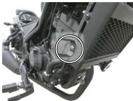
○②ショートステーを本締めする為に、配線接続をし、光軸確認をします。フロントブレーキスイッチの黒/青コードをスイッチから抜き、配線接続図を参照し、①電源オプションコードをフロントブレーキスイッチと黒/青コードの間に接続します。配線処理は①結束バンドを使用して下さい。
