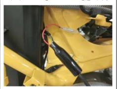
〇配線接続図と画像を参考にギボシを接続し、 配線をブーツの中に入れます。
