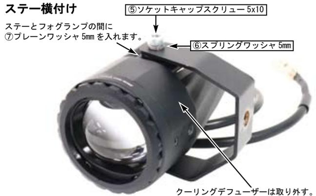
※レンズはガラス製です。そのため、中と外の温度差が大きすぎると、ガラス内側に水滴が出来る時があります。その場合は、下側の水抜きボルトを取り外し、レンズの内側の水滴がなくなるまで水抜きボルトを取り外した状態で中の湿気を逃がして下さい。水滴がない事を確認出来たら水抜きボルトを取り付けて下さい。
