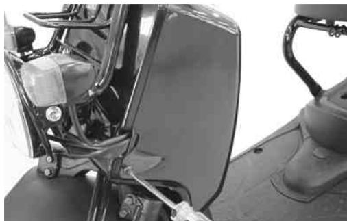
2. ウィンカー及びヘッドライトのコードを固定してあるフロントカバー付属のワイヤバンドを外し、ウィンカーコネクタとヘッドライトコブラの接続を外します。
