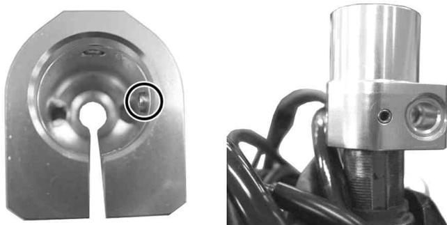
6. ハンドルポスト2をステムシャフトに取り付けたらソケットキャップスクリュー10 X 3 5を取り付け、指定トルクで締め付けます。
