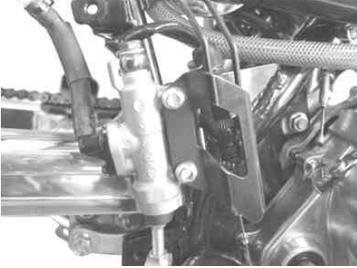
ブレーキペダルからストップスイッチスプリングを取り外します。
