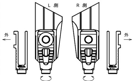
取り付け時は六角ボールポイントドライバーを使用して頂くと整備性が向上します。
