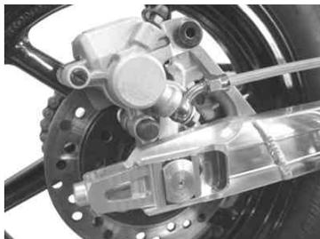
△警告：ディスクローターおよびブレーキパッドに油脂類を付着させない事。
