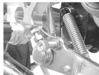
27. リアブレーキの遊びをアジャストナットで調整します。リアブレーキの遊びは10mm~20mmにして下さい。
