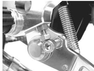
26. ストップスイッチスプリング(26)をブレーキペダルアームの6mmネジ部に合うように加工し、取り付けます。
