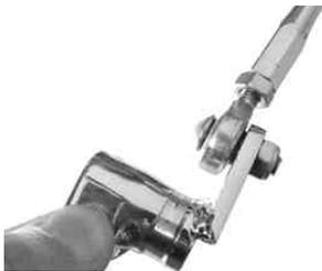
22. チェンジアームCOMP.を上向きにジェネレーターカバーに干渉しないように取り付け、ノーマルのボルトを用いて締め付けます。
