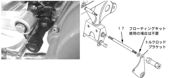
2. 取り外した左クランクケ-スカバ-をマウントナットRに干渉する部分をリュー-タ-等で加工します。(加工後は、バリやカエリが無いようにヤスリ等でエッジ部を面取りして下さい。加工した左クランクケ-スカバ-を取り付けます。
