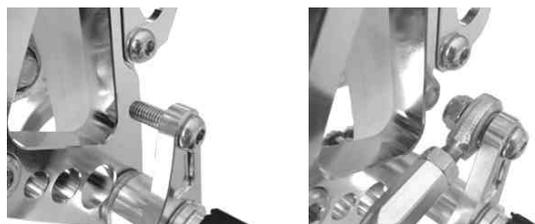
21. もう片方のロッドエンド部にボタンヘッドスクリュー6×20(16)を差し込み、チェンジアームCOMP(8)を取り付け、ロックナット6mm(15)を締め付けます。
