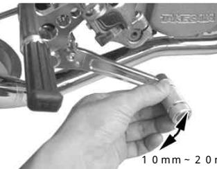
28. ブレーキペダルアームを踏み込んだ時にブレーキランプが点灯するようにストップランプスイッチを調整します。
