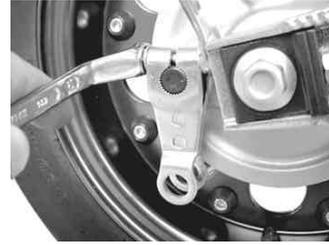
8. ブレーキロッドの加工：弊社製16cmロングスイングアームの0603064(TYPE 1、下スタビ付)や0603065(エキセントリックTYPE 1、下スタビ付)を取り付けている場合はブレーキロッドが干渉します。
