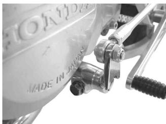
チェンジペダルを動かし、干渉を確認して下さい。干渉する場合は、セレーションをずらして取り付け直し、再度確認して下さい。
