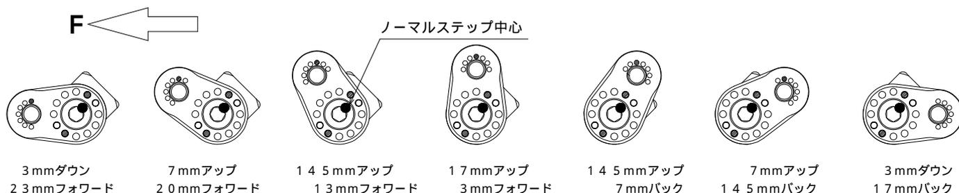
7. ピン位置関係図を参考に ステップブラケットAを ステップブラケットBに ソケットキャップスクリューで取り付けます。
