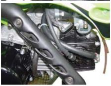
○⑦バンジョーボルト M12x1.0 と、④バンジョー ボルト M8x1.25 を規定トルクで締め付けます。
