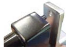
○②フック COMP. の周り止め位置を確認し、写真のように車体に③フラットスクリュー 6x55 で取り付けます。
